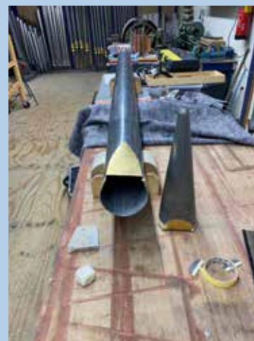
De pijpen waren doorgezakt en worden gedemonteerd en daarna weer netjes in elkaar gezet.
