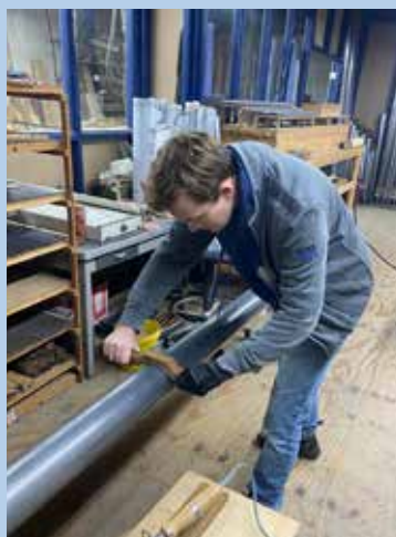
De restaurateur maakt de orgelpijpen weer netjes rond omdat ze door de jaren heen waren vervormd
