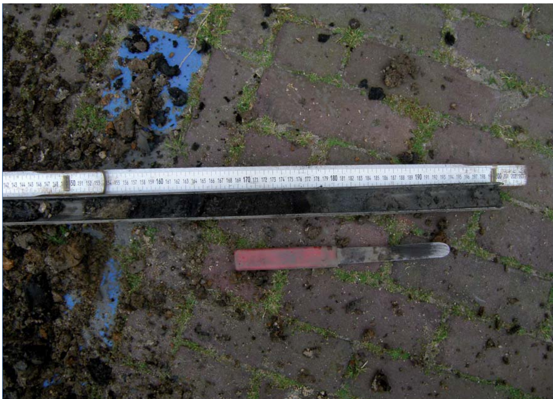
Figuur 8. Enkele van de ophogingslagen die in boring 13 tussen 1,6 en 2 m -Mv zijn aangetroffen. Het is duidelijk waarneembaar dat zowel het veen als de klei heterogeen zijn.
